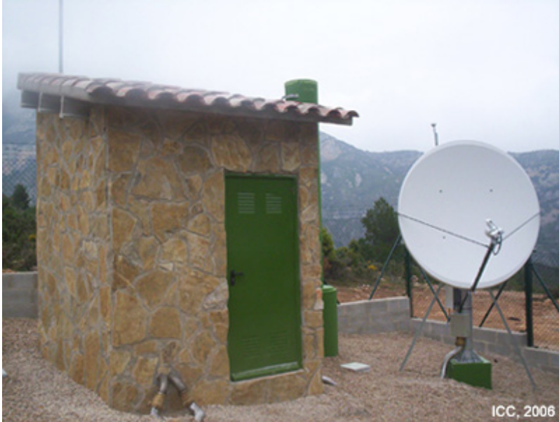
Detall de la caseta instrumental amb l'antena VSAT i el pilar geodèsic
