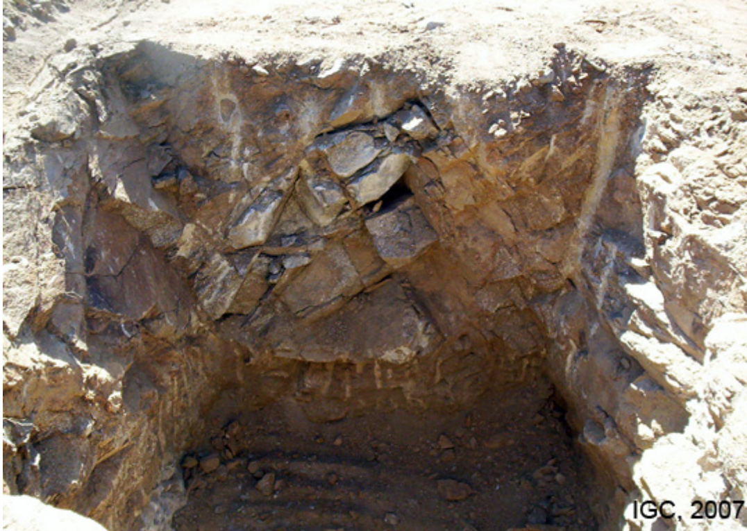
Condicions geològiques de l'emplaçament: aflorament rocós (granodiorita biotiticohornblèndica, Carbonífer-Permià).
